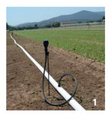
Le support de l'arroseur se fixe sur une tige métal de 8mm (photo1). L'arroseur NETAFIM fileté ½" se visse directement sur le support, sans téflon (les filetages sont coniques), ou sur une embase plastique (photo 2).
